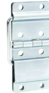
2524 / 2524CHR STRUT HINGE Extra heavy duty strut hinge with backplate. Steel, zinc or chrome plated Strut \varnothing 4.0 mm Fixing holes \varnothing 5.1 mm Weight 80 g FESTSTELLSCHARNIER Besonders schwere Ausführung mit Rückenplatte Stahl, verzinkt oder verchromt Feststeller \varnothing 4,0 mm Befestigungslöcher \varnothing 5,1 mm Gewicht 80 g
