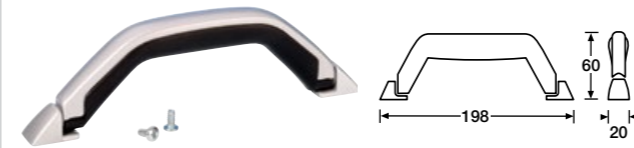
34331 LARGE BRIEFCASE HANDLE Plastic on metallic grey metal frame, die-cast fittings, metallic grey. Supplied 15 mm screws. Weight 110 g. GROSSER KOFFERGRIF Kunststoff auf metallic-grauem Metallrahmen. Druckgußbefestigungen, grau metallisch. Inklusive 15 mm Schrauben. Gewicht 110 g.
