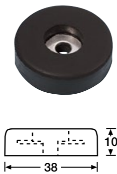
4906 10 mm RUBBER FOOT * Black, with steel insert. Fixing hole \varnothing 6.5 mm, weight 15 g. 10 mm GUMMIFUSS * Schwarz, mit eingelassener Stahlscheibe, Befestigungsloch \varnothing 6,5 mm, Gewicht 15 g.
