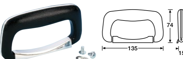
3438 BRIEFCASE DROP HANDLE Quality Briefcase drop handle. Solid black plastic grip with chrome decorative insert. Fixing plate chrome plated diecast. Fixings M5 x 10 mm (supplied), weight 100 g. KOFFERGRIF Hochwertiger Koffergriff, schwarz mit Chromeinsatz. Abdeckkappe Druckguß verchromt. inkl. Schrauben M5 x 10 mm, Gewicht 100 g.
